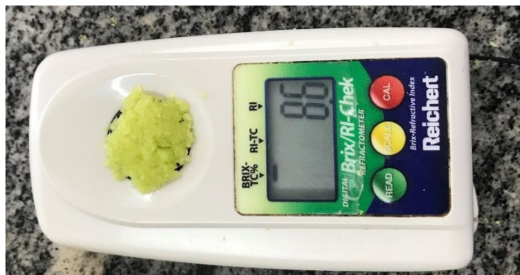
FIGURA 4 – Refratômetro mini digital Reichert, no qual realiza a leitura dos Sólidos Solúveis Totais na amostra da polpa do abacate. Laboratório de pós-colheita, Universidade Estadual de Goiás, Anápolis-GO. 2019.
