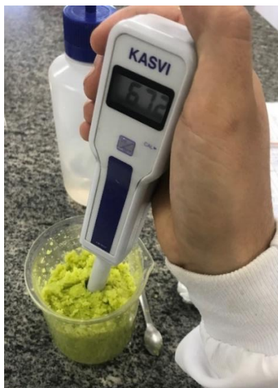
FIGURA 3 – Medidor portátil de pH, para medir a acidez ou a alcalinidade da amostra da polpa do abacate. Laboratório de pós-colheita, Universidade Estadual de Goiás, Anápolis-GO. 2019.
