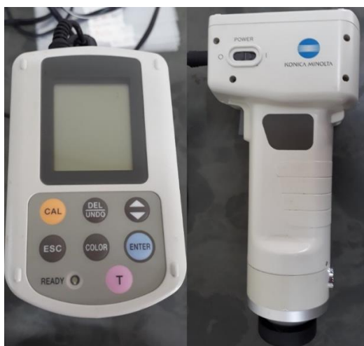
FIGURA 5 – Colorímetro CR - 400 da Konica Minolta, para análise da coloração da casca do abacate. Laboratório de pós-colheita, Universidade Estadual de Goiás, Anápolis-GO. 2019.
