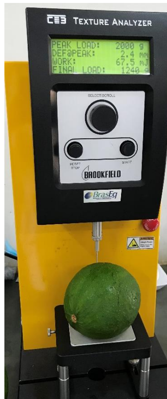
FIGURA 6 – Texturômetro Brookfield - Texture Analyser CT3. Com a finalidade de analisar a firmeza de polpa e de casca do abacate. Laboratório de pós-colheita, Universidade Estadual de Goiás, Anápolis-GO. 2019.
