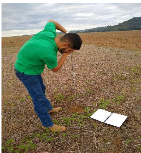
FIGURA 2 – Coleta de dados com penetrômetro de impacto na cidade de Vianópolis - GO, 2019
