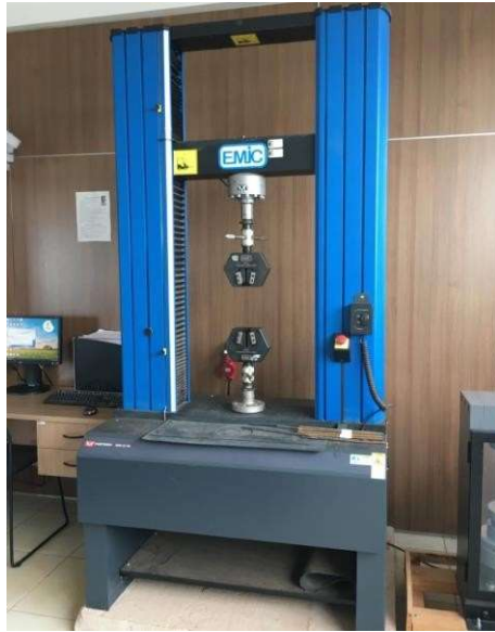
Figura 3.5- Máquina EMIC 23-100 da realização dos ensaios à tração.
