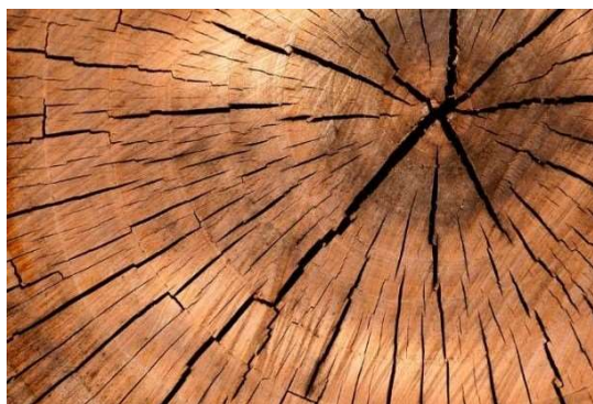
Figura 2.2 – Grã espiralada com rachaduras.
