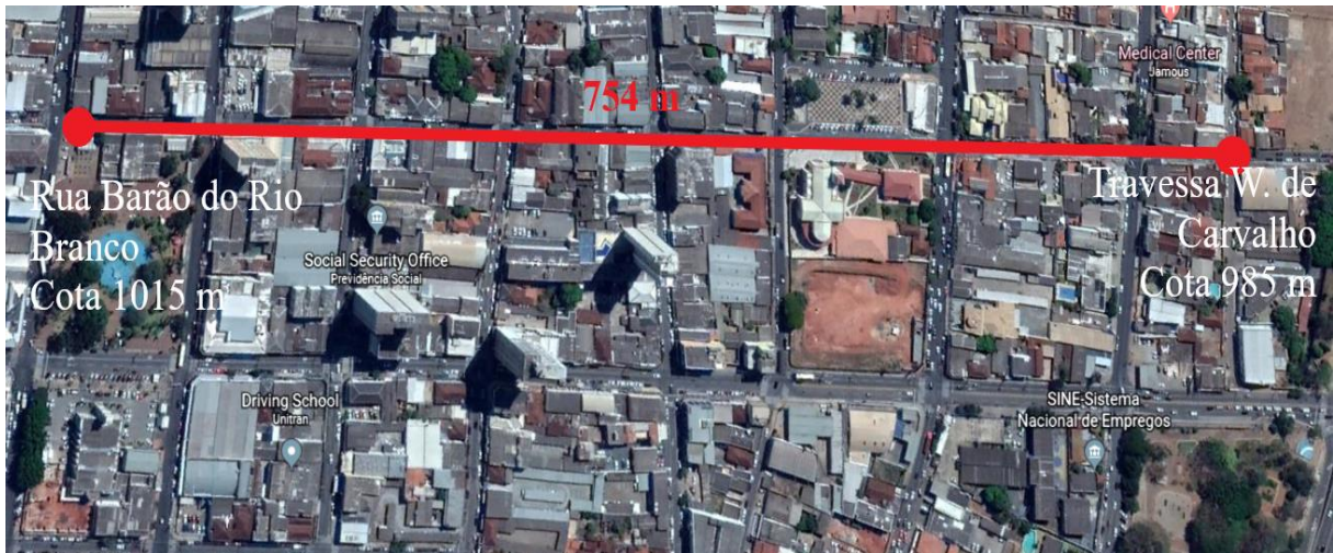
Figura 38 – Esquema adaptado com cotas e distância entre Ruas Washington de Carvalho e Barão do Rio Branco
