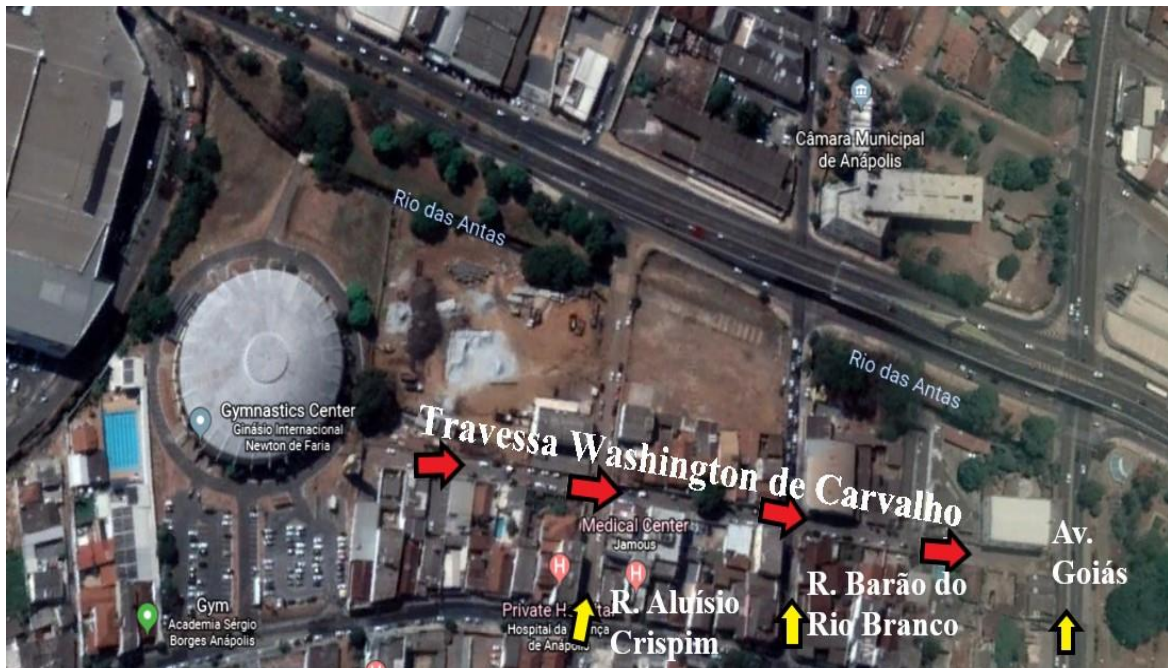
Figura 37 – Mapa esquemático da Travessa Washington de Carvalho com sentido de escoamento das águas pluviais
