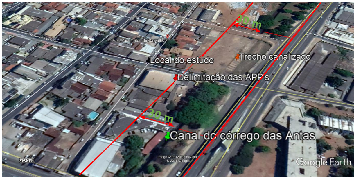
Figura 27 – Disposição do local em estudo, da APP, e do córrego das Antas
