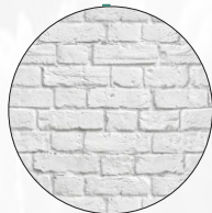
Tijolo cerâmico Revestido de pintura branca fosca acrílica
