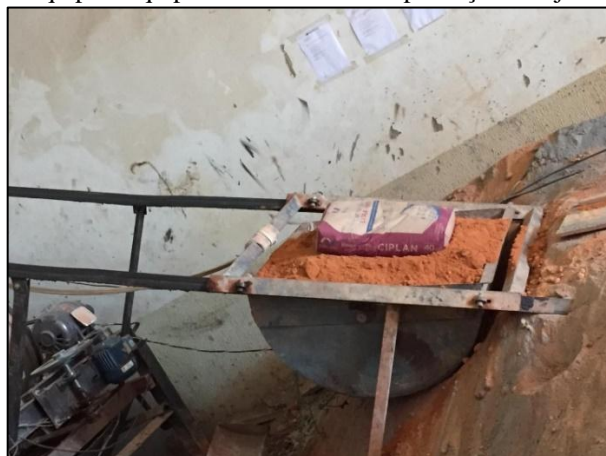
Figura 6- Esquipe – equipamento utilizado na produção de tijolo ecológico
