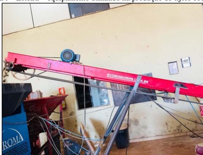
Figura 9 - Esteira – equipamento utilizado na produção de tijolo ecológico
