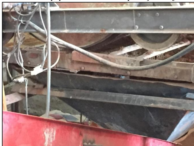
Figura 8 - Peneira – equipamento utilizado na produção de tijolo ecológico
