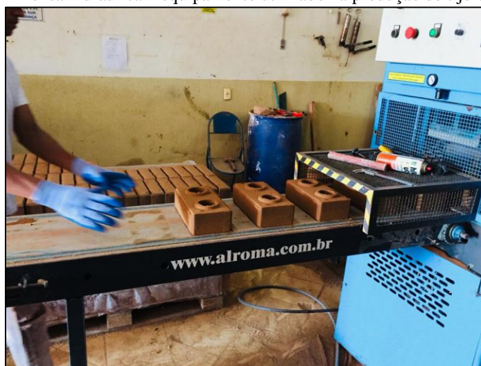
Figura 10 - Prensa hidráulica – equipamento utilizado na produção de tijolo ecológico
