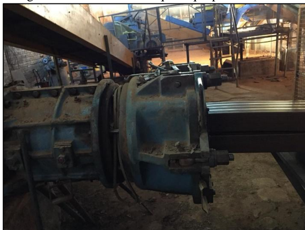
Figura 17 - Maromba – máquina que prensa e molda.
