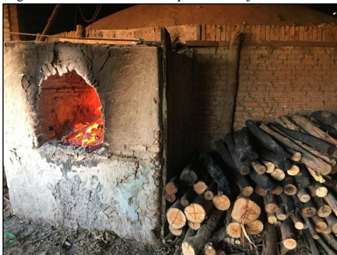
Figura 21 - Forno utilizado na queima dos tijolos cerâmicos.
