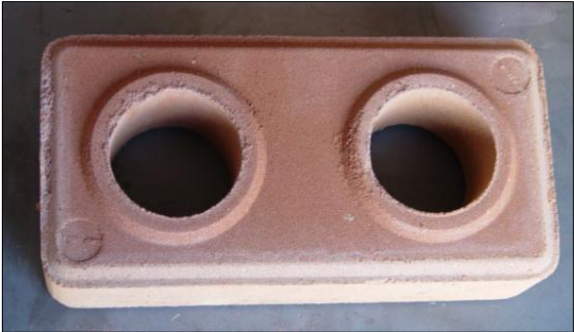
Figura 1 – Detalhes dos furos com encaixe saliente, que fica em cima durante o assentamento, do tijolo solo-cimento com 6,25 x 12,5 x 25 cm
