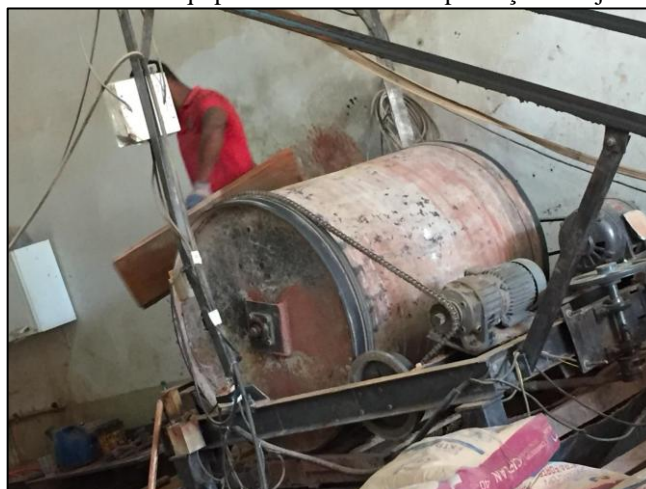
Figura 7 - Misturador – equipamento utilizado na produção de tijolo ecológico
