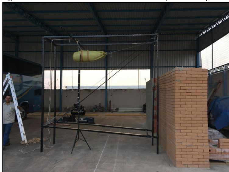
Figura 27 - Procedimento executivo do teste de impacto de corpo mole
