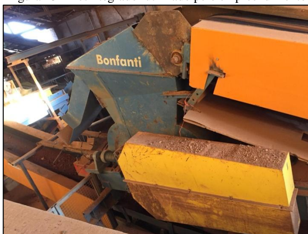
Figura 15 - Desintegrador utilizado pelo empreendimento
