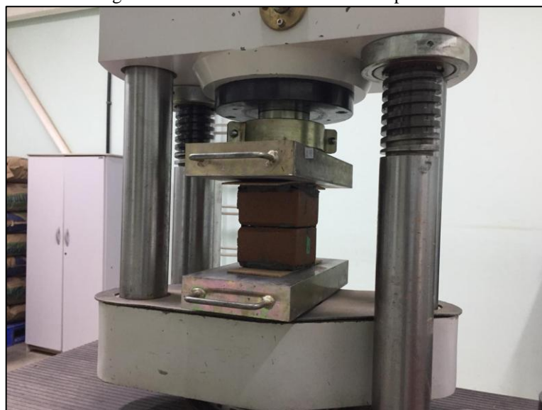
Figura 29 - Ensaio de resistência a compressão.
