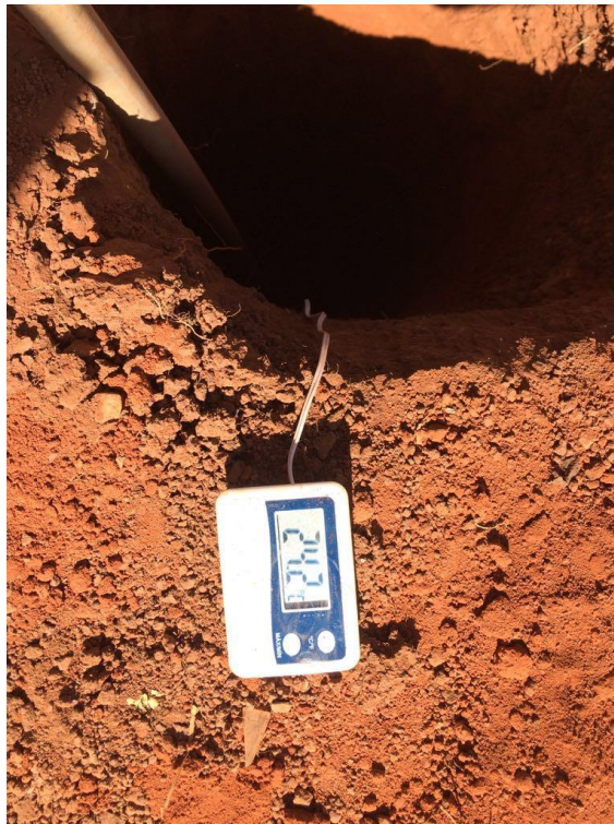
Foto 9- Aferição da temperatura do buraco 03
