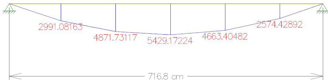
Figura 11 - Diagrama do momento solicitante de cálculo da viga tipo V11
