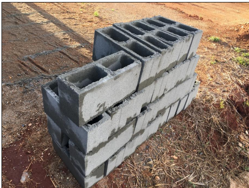
FIG. 3.3.3 - Blocos de concreto com escória de FeNi fabricados pela Goiás Postes.
