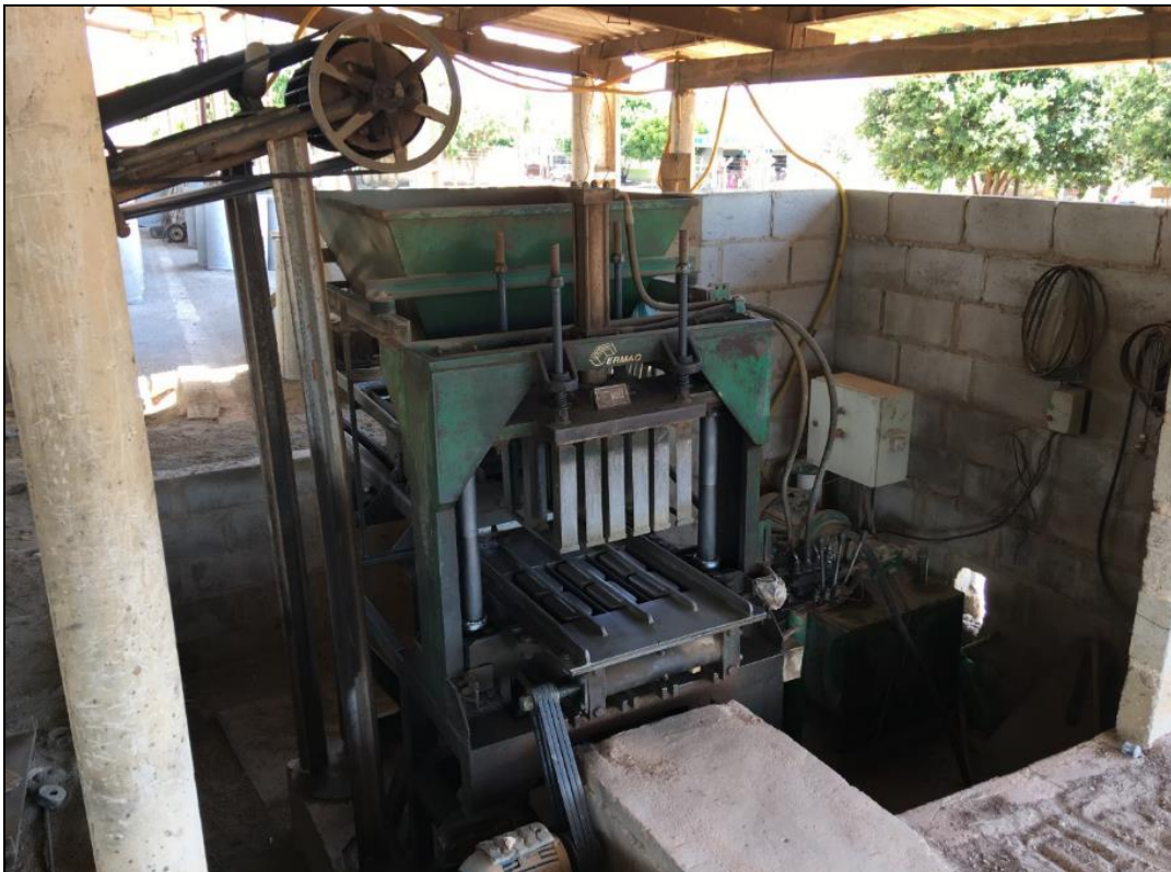
FIG. 3.3.2 - Máquina para moldar e compactar blocos de concreto.
