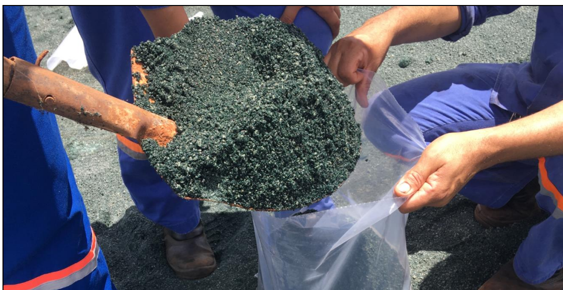
Figura 3.1.1 - Coleta de amostra de escória de ferro-níquel para ensaios laboratoriais.
