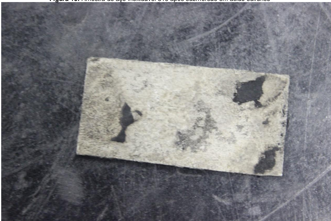
Figura 15: Amostra de aço inoxidável 316 após submersão em ácido sulfúrico
