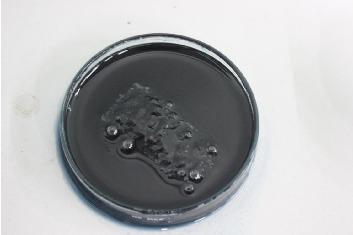
Figura 14: Aço inoxidável 316 com 3 semanas de submersão em ácido sulfúrico
