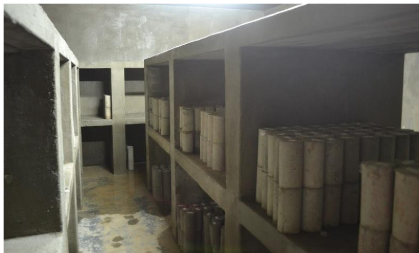
Figura 5: Câmara Úmida – Fonte: Google Fotos de câmara umida
