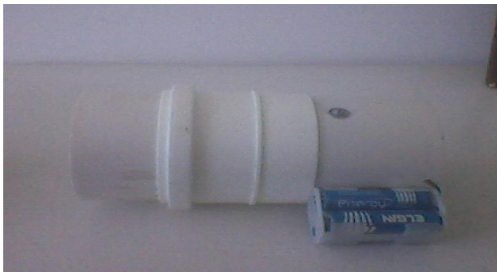
Figura 14 - Capturador manual a pilha (Shannon). Fonte: Pirajá e Lucheis (2014)
