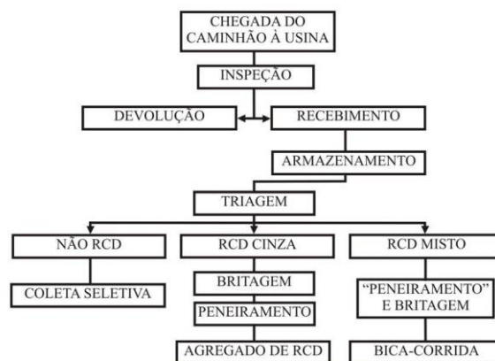
Figura 3 - Procedimento do RCD a partir da chegada na Usina.
