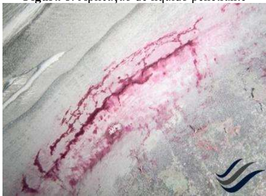
Figura 8: Aplicação de líquido penetrante
