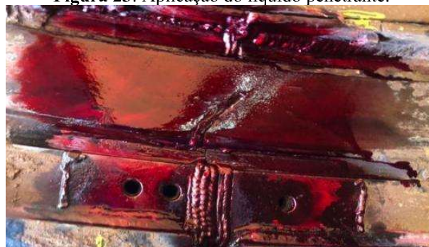
Figura 23: Aplicação do líquido penetrante.
