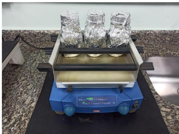
**Figura 3-** Amostras com solventes, envolvidas em papel alumínio, o agitador por 24h.
