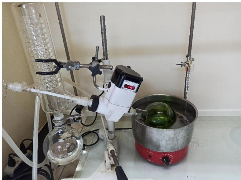
**Figura 5-** Filtrado no rotaevaporador.
