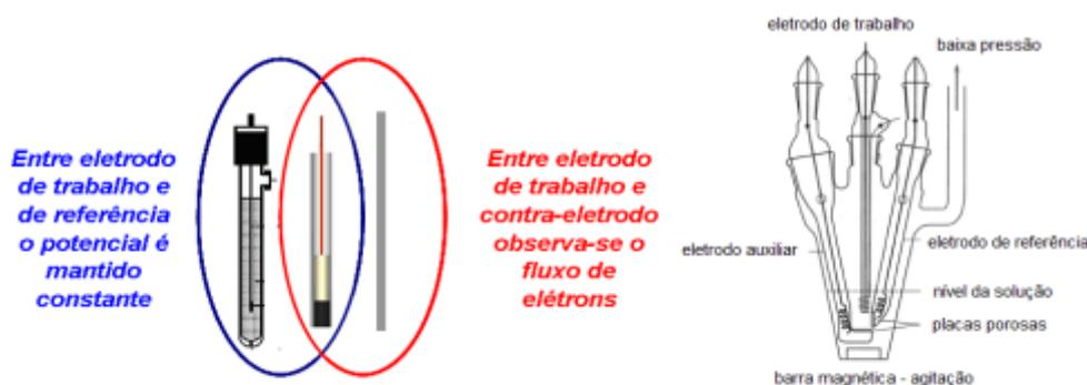
**Figura 1.** Configuração de um sistema envolvendo três eletrodos.
