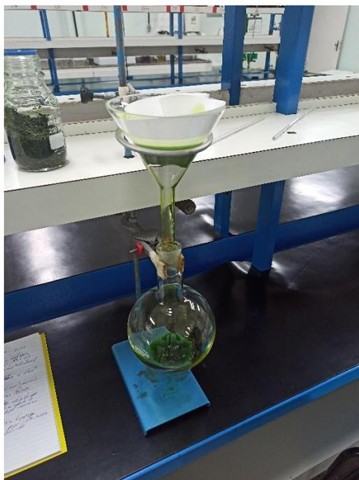
**Figura 4-** Amostra sendo filtrada em papel filtro.
