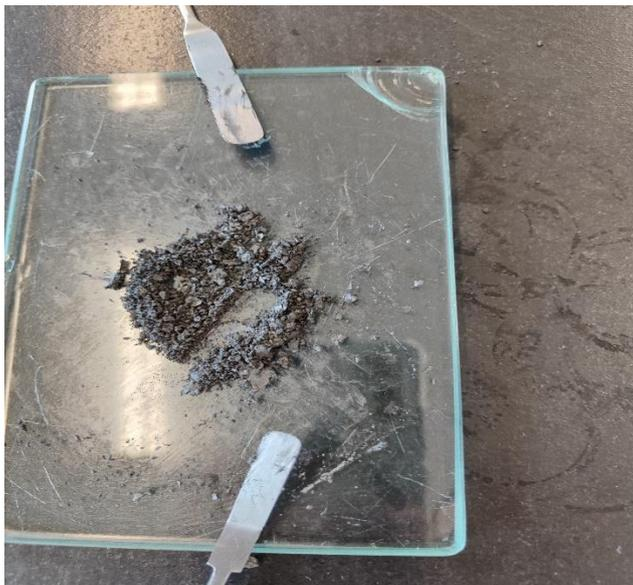
**Figura 6-** Pasta homogênea composta de pó de grafite (1,1 g) e óleo mineral (450 mg).
