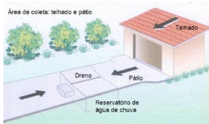
Figura 10 - Área de captação - telhado e pátio
