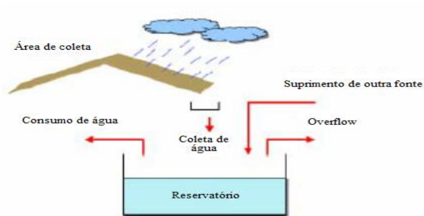
Figura 1 – Esquema de aproveitamento de água de chuva
