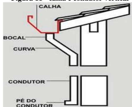
Figura 11 - calha e condutor vertical
