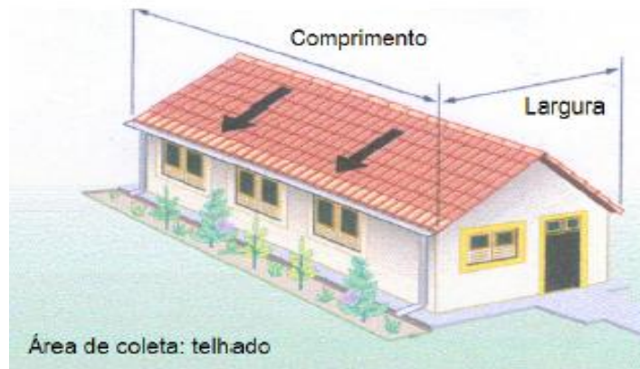
Figura 8 - Área de captação - telhado
