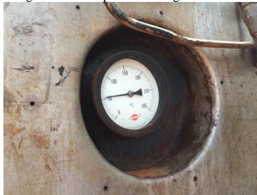
Figura 47 – Temperatura do ligante asfáltico
