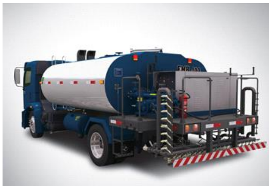
Figura 11 – Caminhão espargidor de asfalto Fonte -
