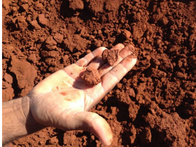
Figura 25 - Material com excesso de umidade
