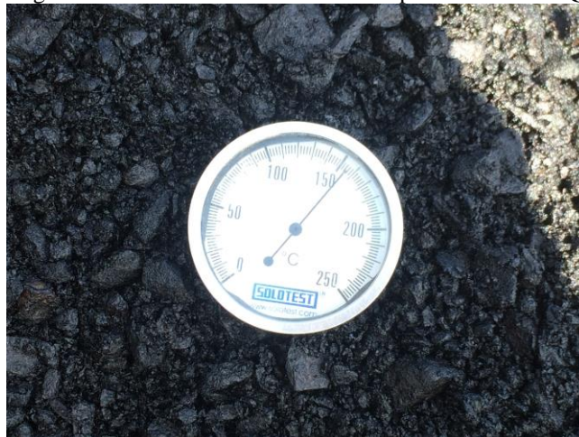
Figura 50 – Termômetro medindo a temperatura do CBUQ
