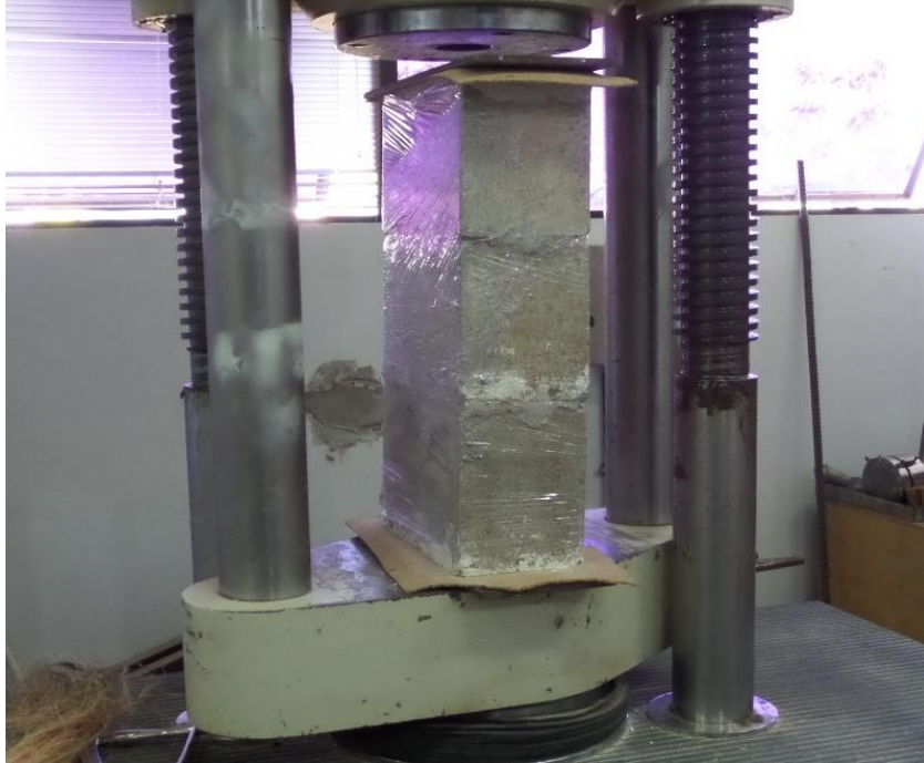
Figura 24 – Utilização da folha de cortiça e chapa de aço no rompimento
