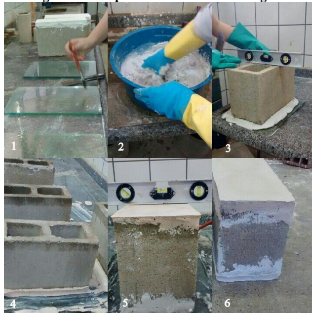
Figura 11 – Capeamento dos blocos com gesso
