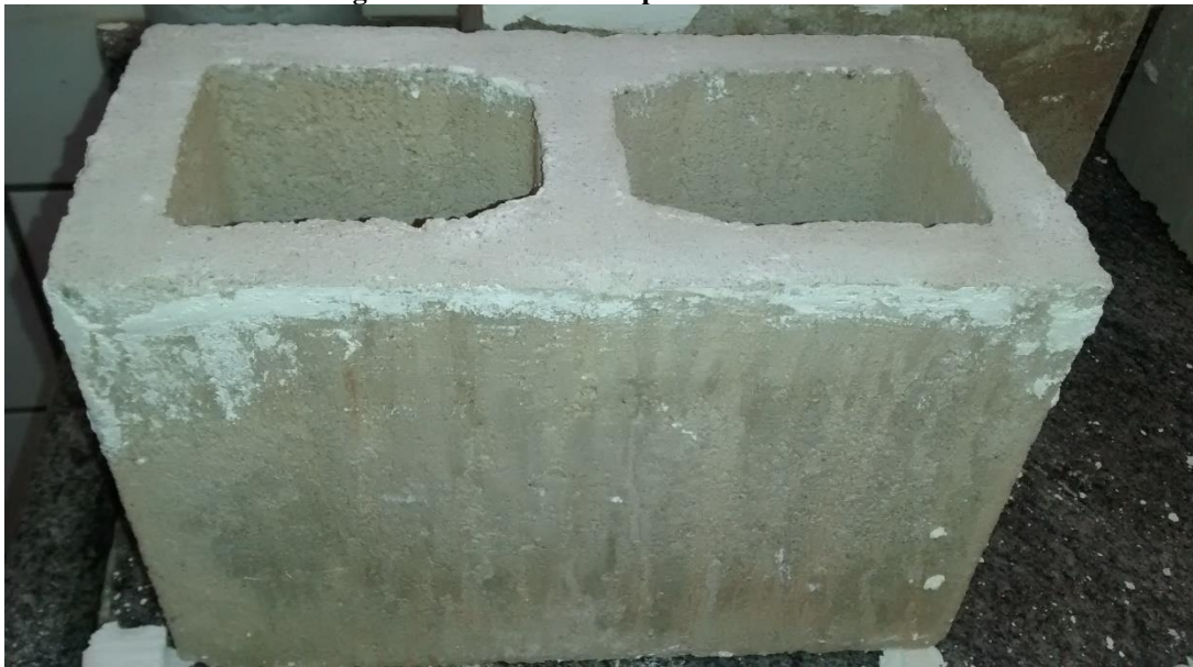
Figura 21 – Bloco com capeamento retirado
