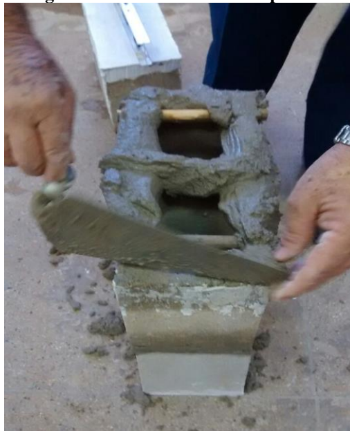
Figura 19 – Assentamento dos prismas
