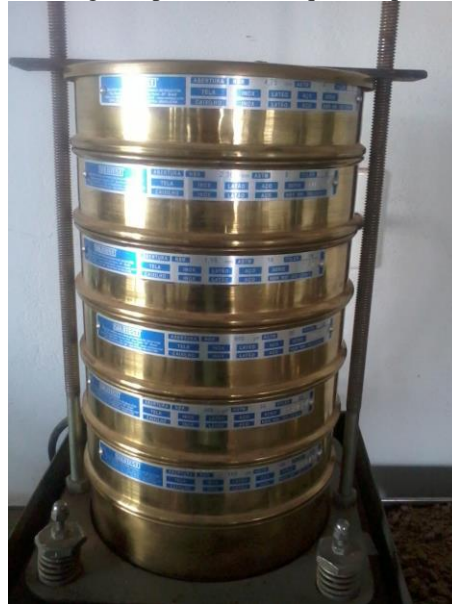
Figura 13 - Jogo de peneiras na sequência para o ensaio.
