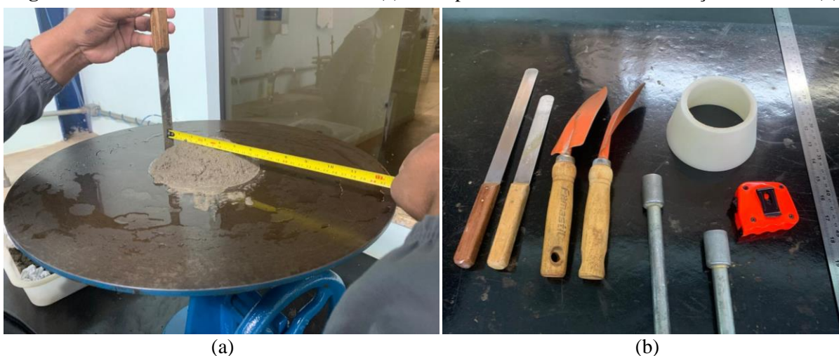
Figura 4 – Ensaio de índice de consistência (a) e componentes utilizados na realização do ensaio (b).
