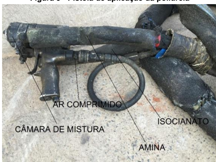
Figura 5 - Pistola de aplicação da poliureia
