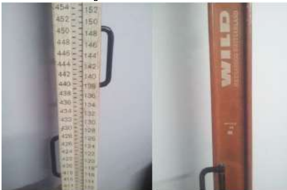
Figura 8 - Mira com barra Invar
