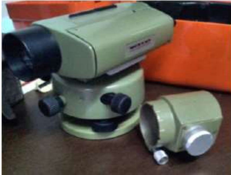
Figura 7 – Nível óptico de precisão Wild Heerbrugg N2 e Micrômetro nível de precisão
