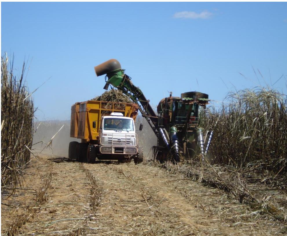
Figura 12 – Colheita mecanizada de cana queimada
