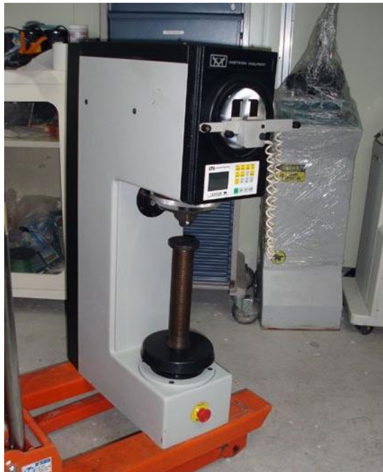
Figura 5 - Equipamento Instron - Wolpert modelo 930/250 a ser utilizado no ensaio de dureza Rockwell.
