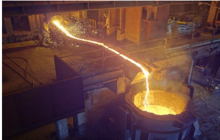
Figura 2 - Metal bruto sendo vazado do forno elétrico para o forno panela.
