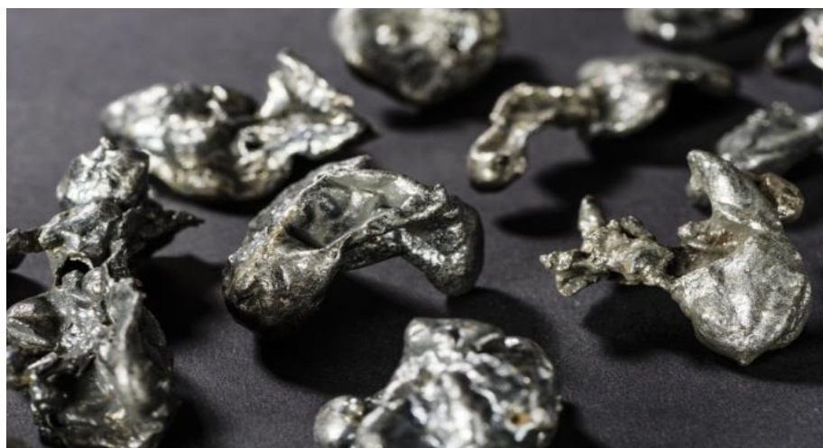
Figura 4 - Ferroníquel obtido após a etapa de refino.
