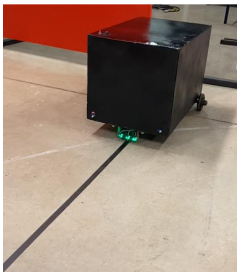
Figura 15 – Testando sensores de faixa
