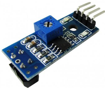
Figura 07 – Sensor de Linha Infravermelho TCRT5000 e o sensor de obstáculo.
