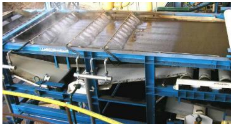
Figura 3 - Representação do sistema de embebição.
