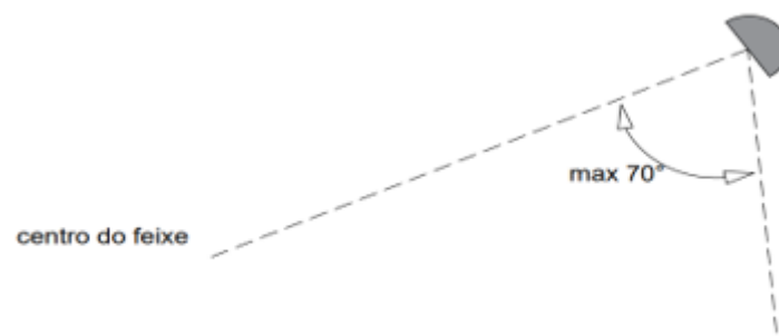
Figura 2. Ângulo Máximo do Refletor com a Normal
