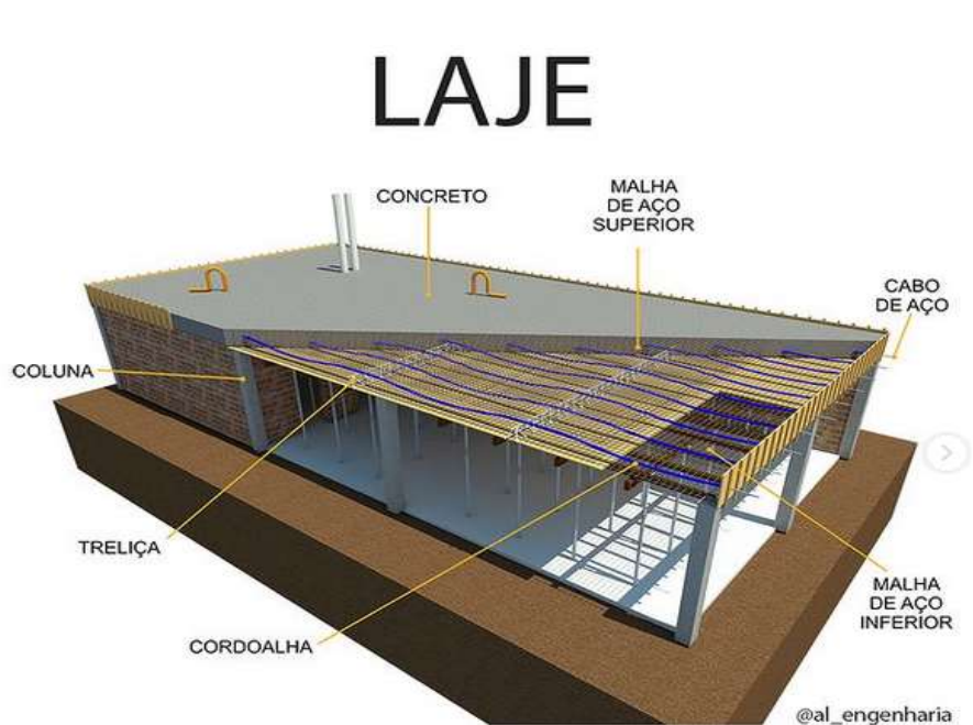
Figura 3 - Detalhes construtivos de lajes – laje protendida
