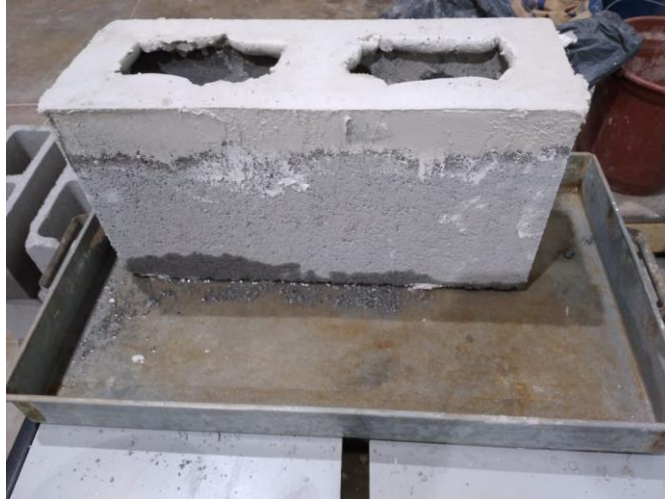
Figura 24 - Ensaio de absorção de água – saturação
