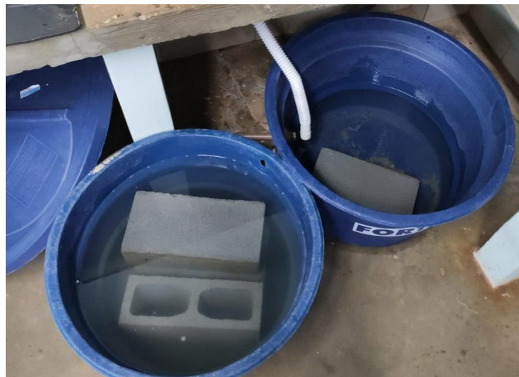
Figura 23 - Ensaio de absorção de água – saturação
