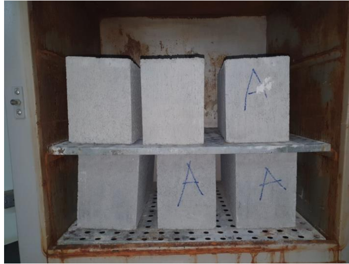
Figura 20 - Ensaio de absorção de água – estufa
