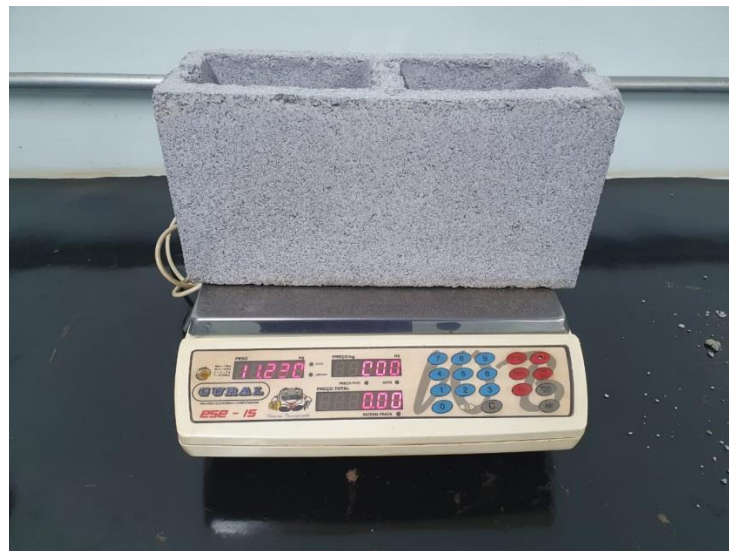
Figura 21 - Ensaio de absorção de água- massa seca
