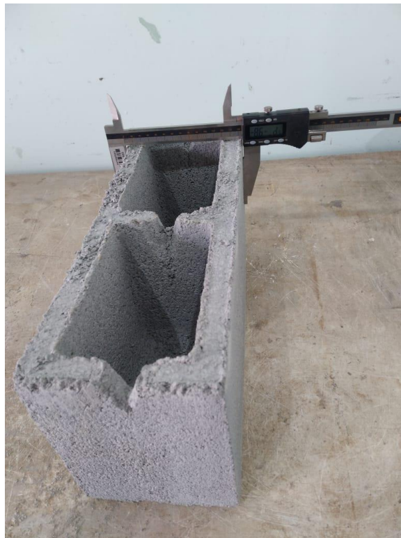
Figura 19 - Largura do bloco – paquímetro
