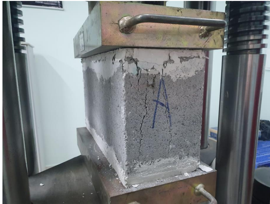
Figura 31 - Rompimento do bloco
