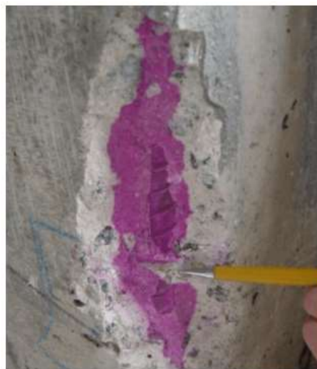
Figura 11 – Ensaio de carbonatação com fenolftaleína
