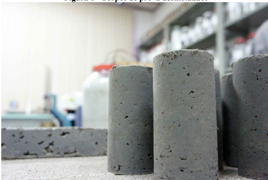
Figura 6– Corpos de prova desmoldados
