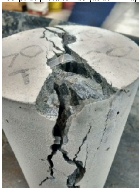
Figura 12– Corpo de prova com adição de PET após ruptura.
