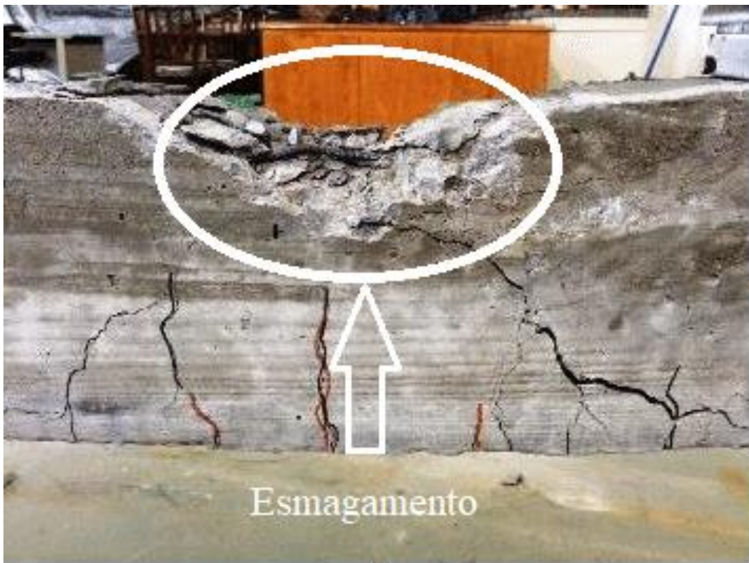
Figura 9 – Esmagamento do concreto
