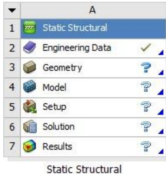
Figura 16 – Parâmetros da análise estática estrutural
