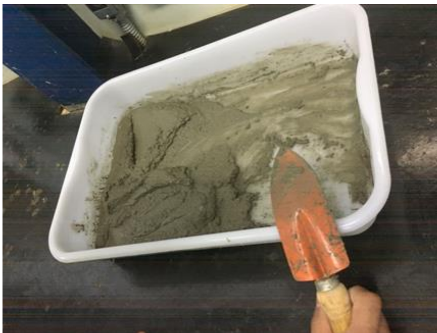
Figura 11: Preparo da argamassa para ensaio de Índice de Consistência.
