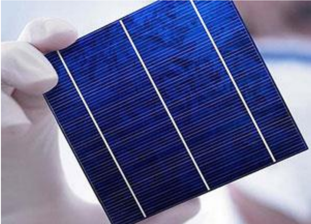
Figura 3 - Placa fotovoltaica: captação de energia solar pelo método direto.
