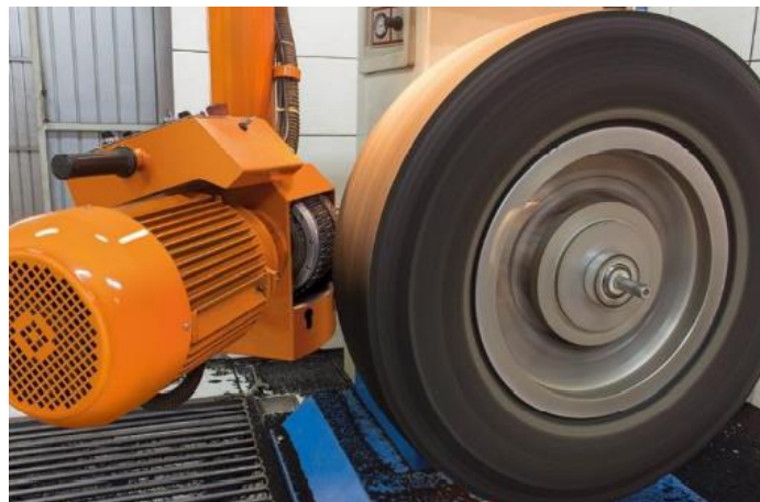
Figura 12 - Raspagem mecânica do pneu
