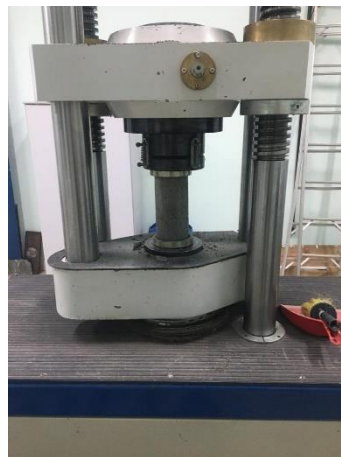
Figura 17 - Ruptura do corpo-de-prova
