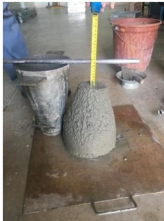
Figura 16 - Medição do abatimento do concreto
