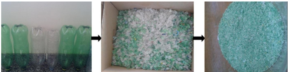
Figura 9 - Transformação da garrafa PET
