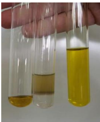
Figura 22 – Reações de caracterização de heterosídeos cardioativos: tubos teste, com a fração clorofórmica do extrato de J. pectoralis ., da esquerda para a direita, Reação de Liebermann-Burchard, Reação de Keller-Kiliani, Reativo de Kedde.
