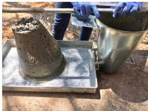
Figura 5 – Ensaio de abatimento do tronco cone.
