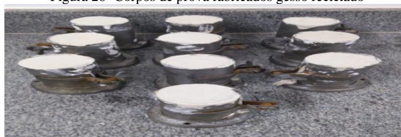
Figura 26- Corpos de prova fabricados gesso reciclado
