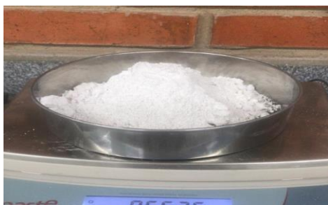
Figura 33- Imagem de ensaio de consistência normal
