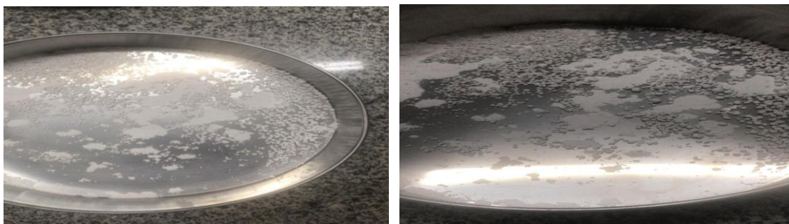
Figura 30- Detalhe do material passante na peneira de 200 mm (A) Gesso Reciclado (B) Gesso Comercial
