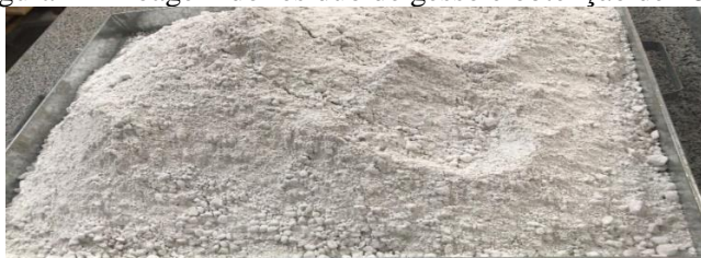
Figura 12-Moagem do resíduo de gesso e obtenção de 28 kg
