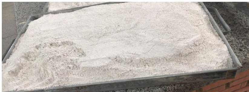
Figura 14- Resíduo após realizado peneiramento
