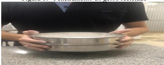
Figura 19- Peneiramento do gesso reciclado
