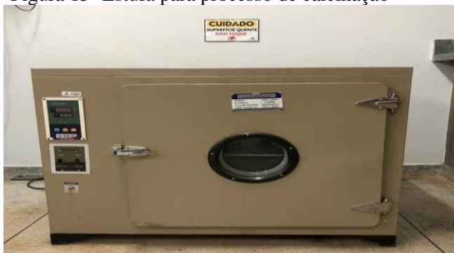
Figura 15- Estufa para processo de calcinação
