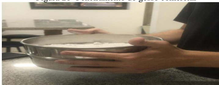
Figura 20- Peneiramento do gesso comercial
