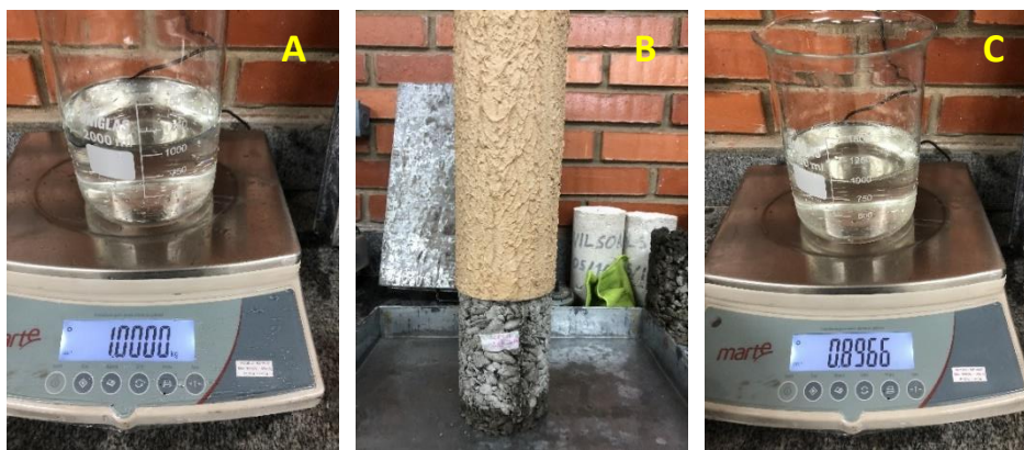
Figura 11 – Água inicial (a). Cano de PVC nos corpos de prova (b). Pesagem da água infiltrada (c).
