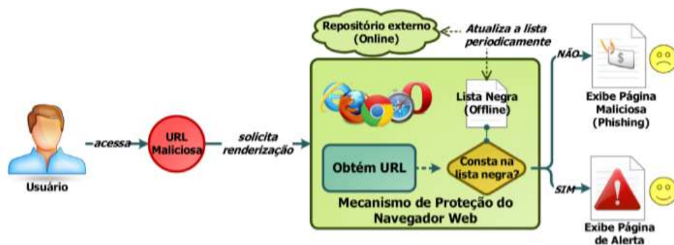
Figura 6 – Exemplo do mecanismo de proteção dos navegadores contra phishing Fonte: SILVA et al. (2017, p. 375)
