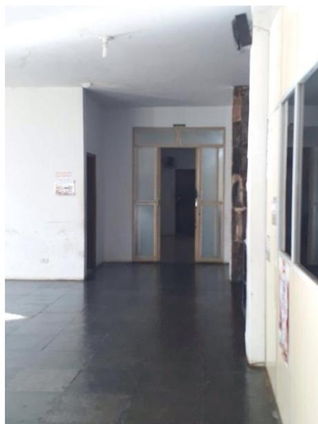
Imagem 10: Corredor da Prefeitura Municipal sem piso guia para cegos, com portas de acesso estreitas e sem placa de identificação em braile.
