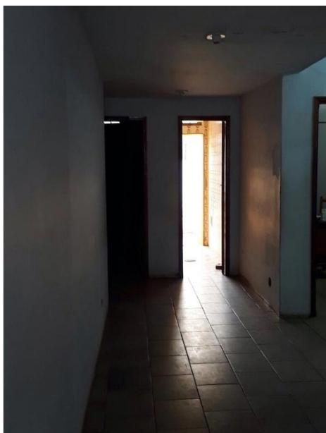
Imagem 09: Corredor da Prefeitura Municipal sem piso guia para cegos, com portas de acesso estreitas e sem placa de identificação em braile.
