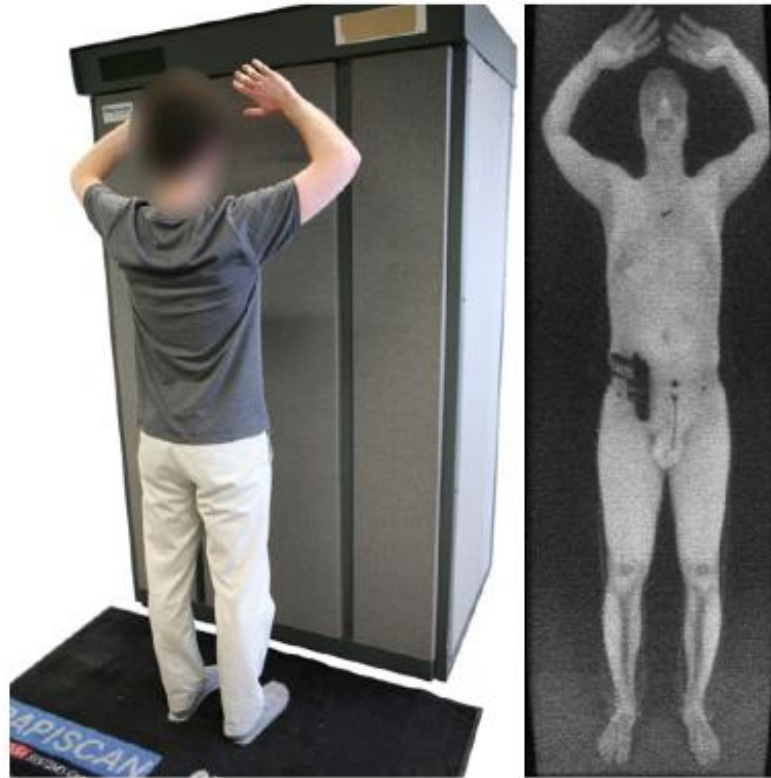
Figura 1- Scanner Corporal detecta armas e objetos suspeitos
