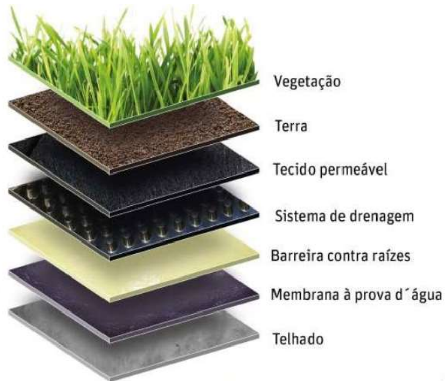
Figura 2.1 - Camadas do telhado verde.
