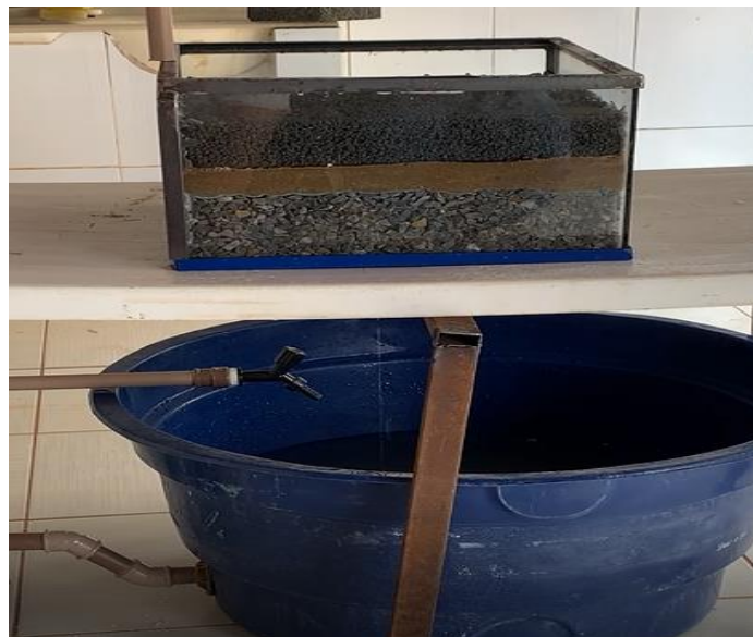
Figura 3.10 Pavimento completamente drenado.
