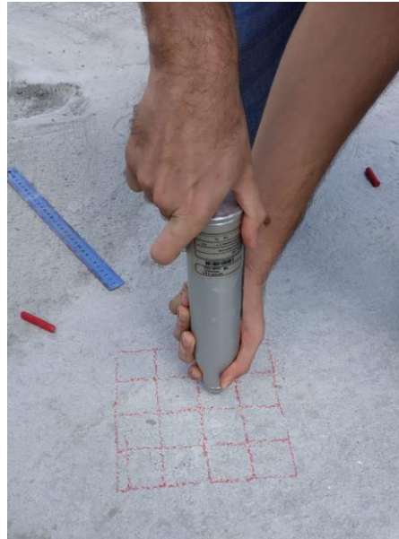
Figura 9 – Realização do ensaio esclerométrico.
