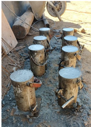
Figura 11 – Moldagem dos corpos de prova.
