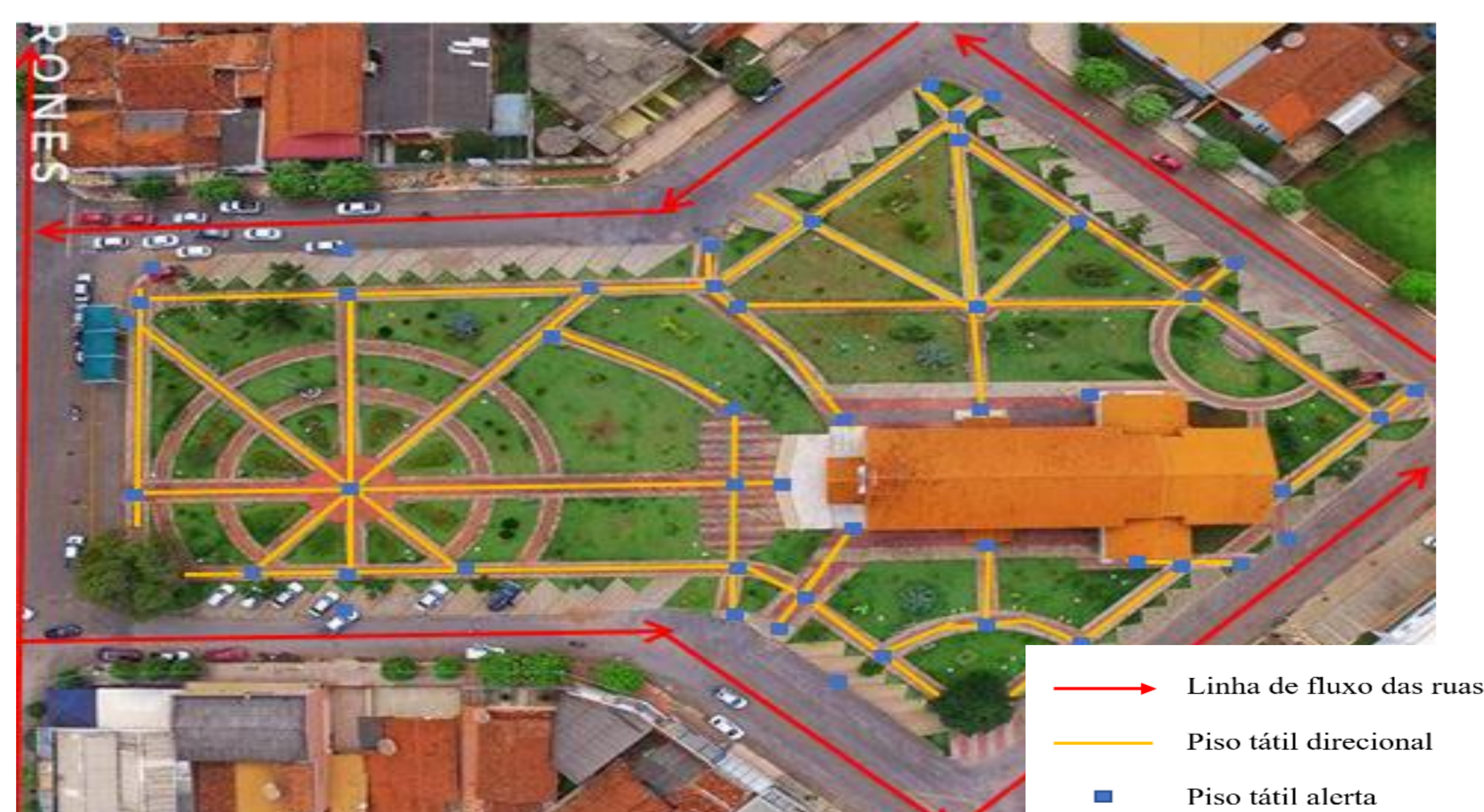
Figura 1. Diagrama de circulação e mapa tátil da Praça Jeribá em Rubiataba (Adaptado de ElevDrones, 2017).
