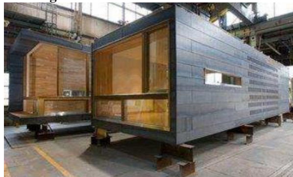
Figura 6 - Unidade modular em fábrica
