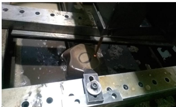
Figura 5 - Processo de fabricação das amostras, A - Cabeça do martelo
