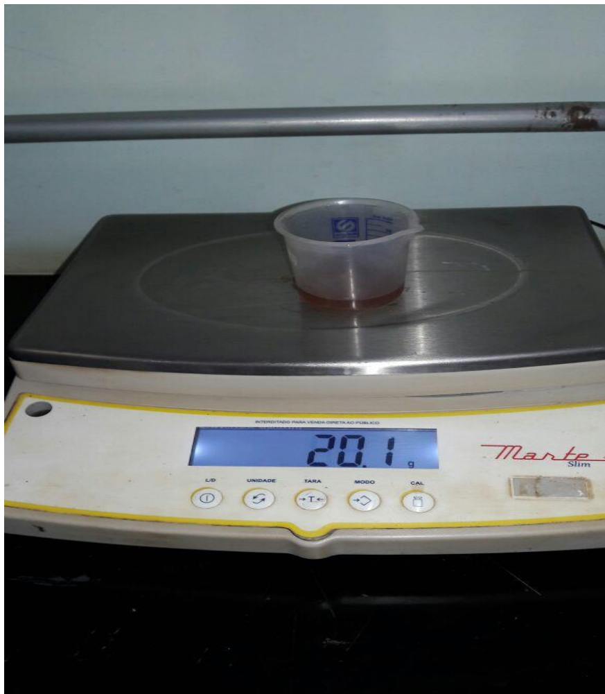
Figura 8- Pesagem aditivo plastificante
