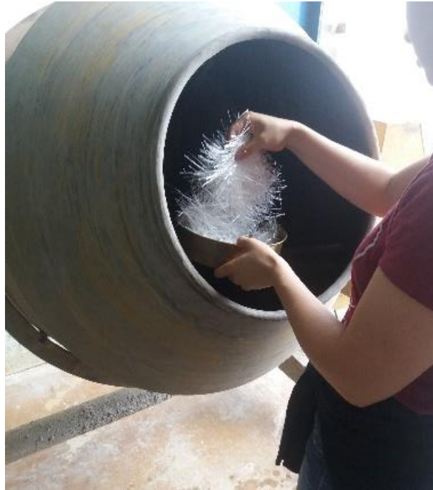
Figura 15 – Colocação das fibras de vidro
