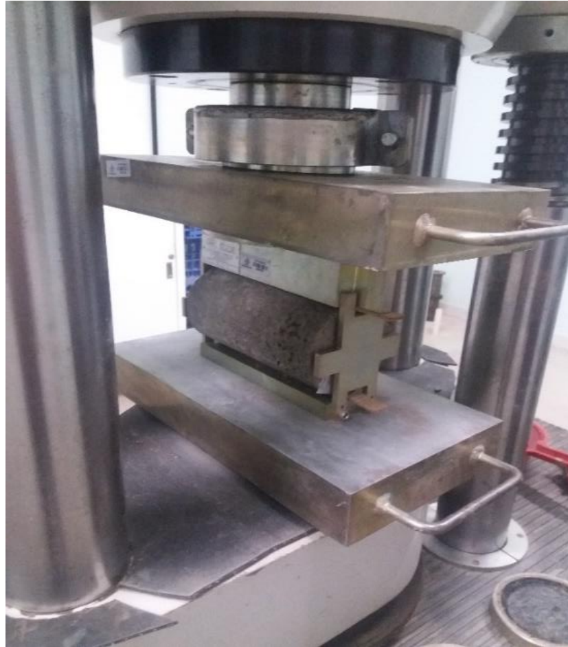
Figura 21– Ensaio de ruptura a tração por compressão diametral.
