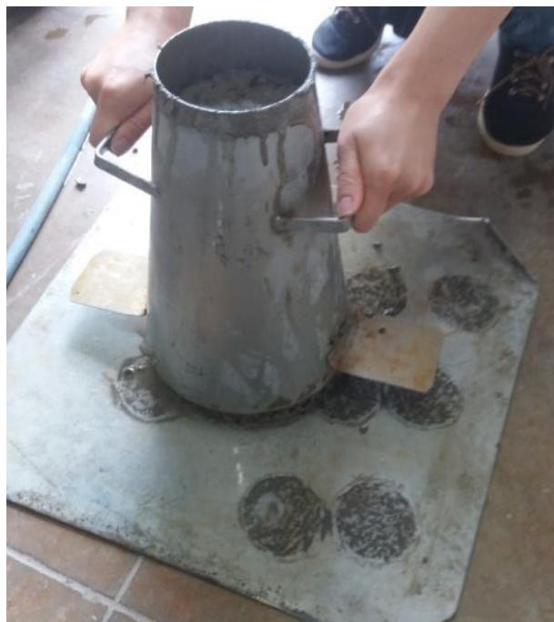
Figura 19– Desmolde do corpo de concreto
