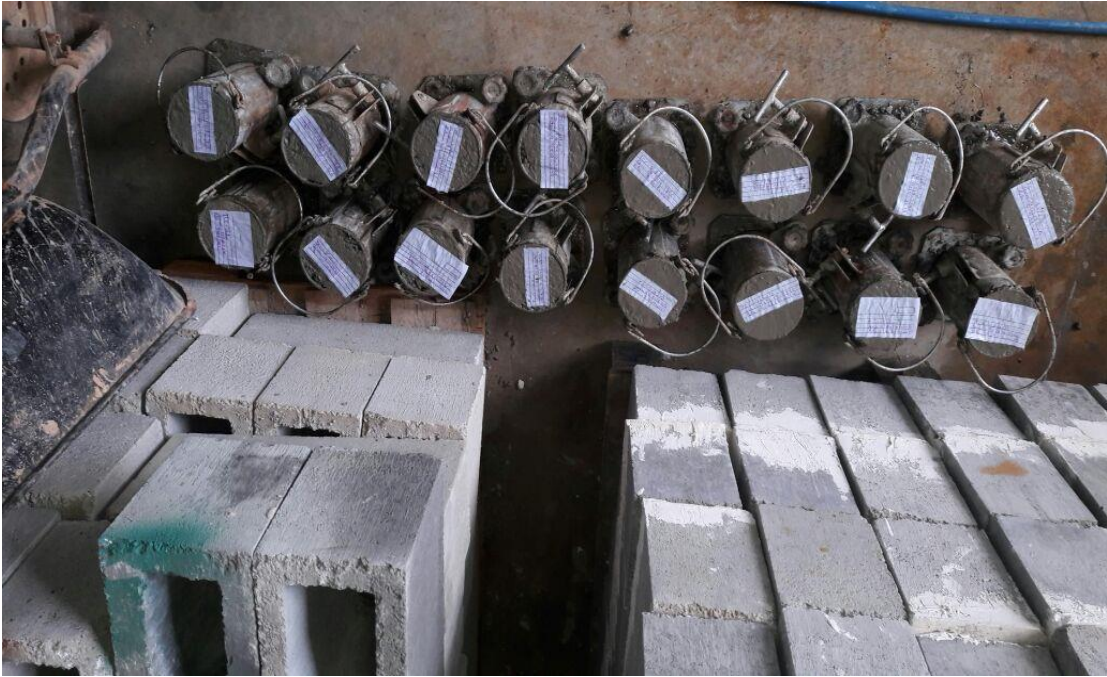
Figura 4: Confeção dos corpos de prova com fibras de vidro
