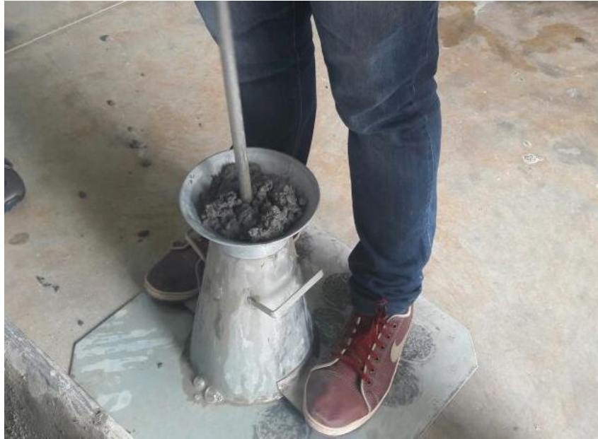
Figura 18– Preenchimento do molde e compactação com a haste metálica
