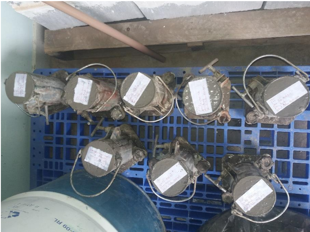
Figura 5: Confeção dos corpos de prova sem fibras
