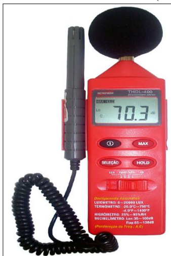
Figura 1 – Termo-Higro-Decibelímetro Luxímetro (Modelo: THDL-400).
